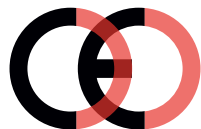
Falsk CE-mærke (for tæt på hinanden)
